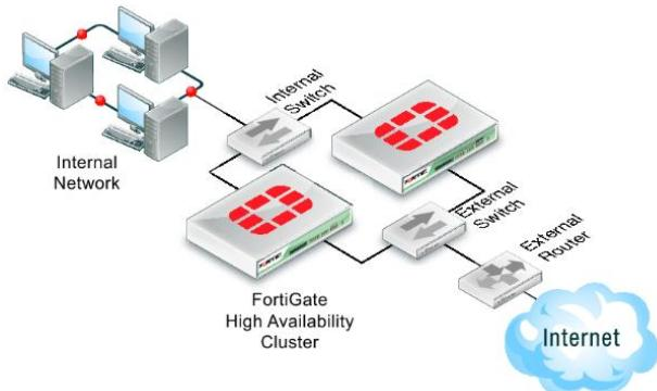
For lokasjoner med forretningskritiske systemer med høye krav til tilgjengelighet, er redundans det beste alternativet. Adskilte fysiske og logiske føringsveger sikrer at aksessene alltid er tilgjengelige. Redundante løsninger tilpasses kundens behov.
